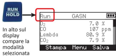
Con le frecce ▲▼ si scorrono i dati sul display
